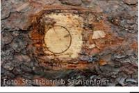
8 **Exzentrizität** bezeichnet die Abweichung der Lage der Markröhre vom geometrischen Mittelpunkt der Querschnittsfläche des Rundholzes. Der Mittelpunkt ist der Schnittpunkt zweier senkrecht zueinander stehender Durchmesser (D1 und D2, ohne Rinde). An der Stirnfläche ist der Abstand (A) der Markröhre vom Mittelpunkt zu erheben und als Prozentsatz, bezogen auf den mittleren Durchmesser der betreffenden Stirnfläche anzugeben:  $A / ((D1 + D2) / 2) * 100$
