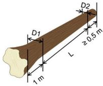
Der Durchmesser ohne Rinde (bei unregelmäßigen Querschnitten aus zwei senkrecht zueinander stehenden Messungen abgeleitet) ist mindestens 50 cm von den Stammenden zu messen, bei Erdstammstücken 1 m vom stärkeren Ende entfernt.
